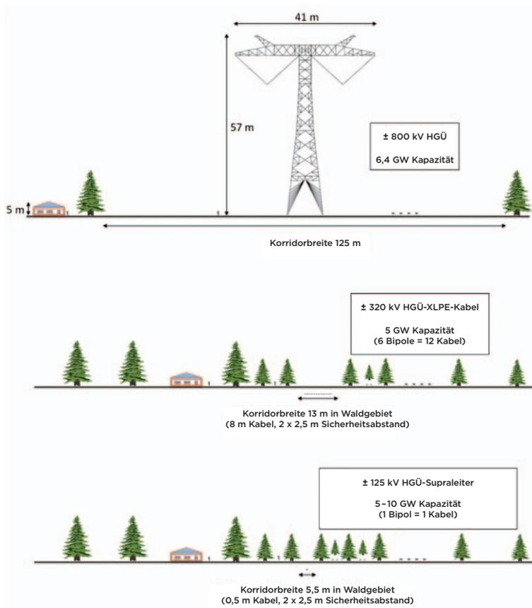
Größenvergleich unterschiedlicher technischer Optionen für den Stromtransport.
